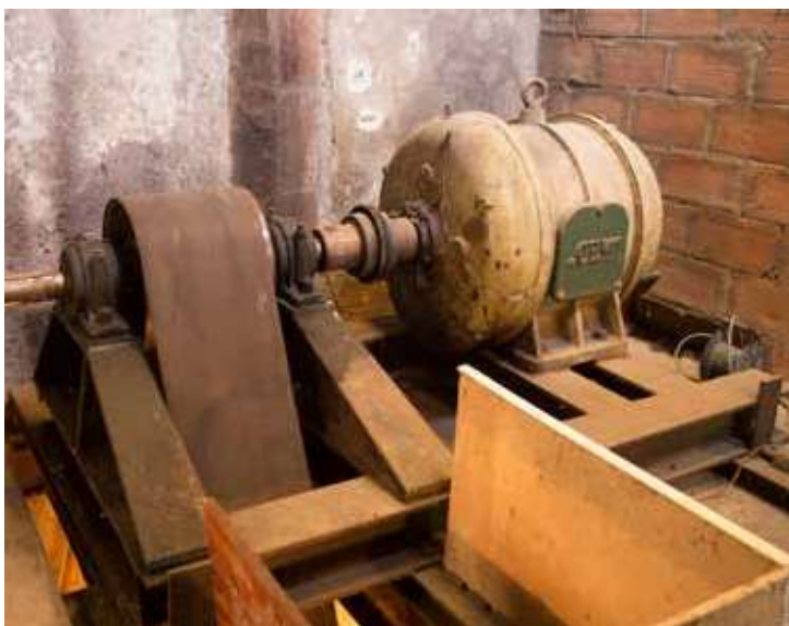
L'alternateur et la courroie à bande plate
